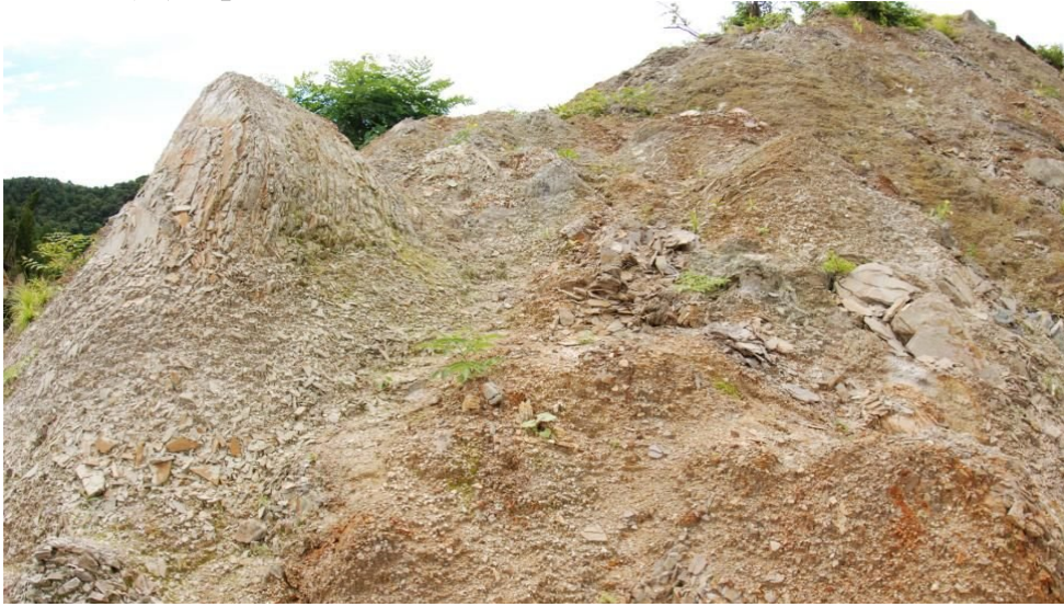
風化の進行のしかたは節理面の露出方向により異なっている
