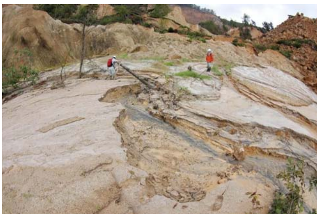
地すべり右側壁と第2リッジの間に発生した窪地に流入・堆積した土砂さらに二次侵食を受け、縦横に削りとられている
