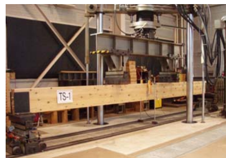
図2 接着重ね梁の強度試験 (スギ、長さ6m、3層)
