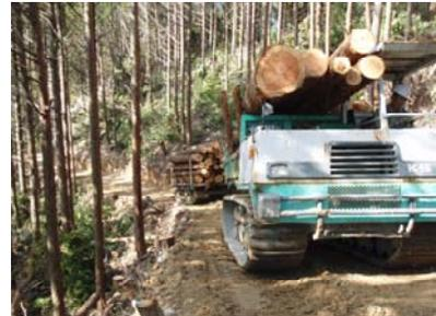
(グラップルで集材) → (プロセッサで造材) → (フォワーダで搬出)
