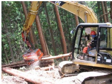
(グラップルで集材) → (プロセッサで造材) → (フォワーダで搬出) (低コストで高効率な作業システムの例)
