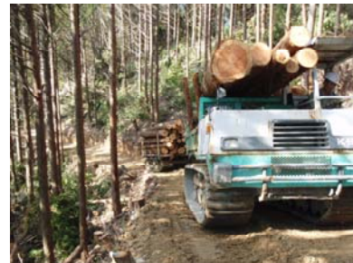
(グラップルで集材) → (プロセッサで造材) → (フォワーダで搬出) (低コストで高効率な作業システムの例)
