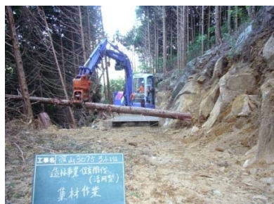
(グラップルで集材) → (プロセッサで造材) → (フォワーダで搬出) (低コストで高効率な作業システムの例)
