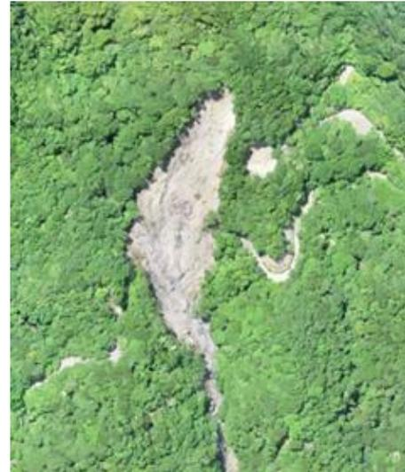
ドローンで撮影し、PhotoScanによりオルソ画像化。
