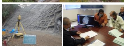
レーザスキャナを活用した出来形計測と検査 (四万十署)
