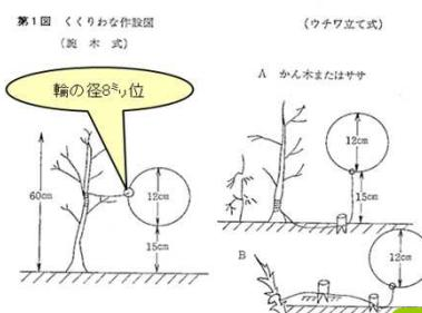
ノウサギ用くくりわなおよび作設図(イメージ)
