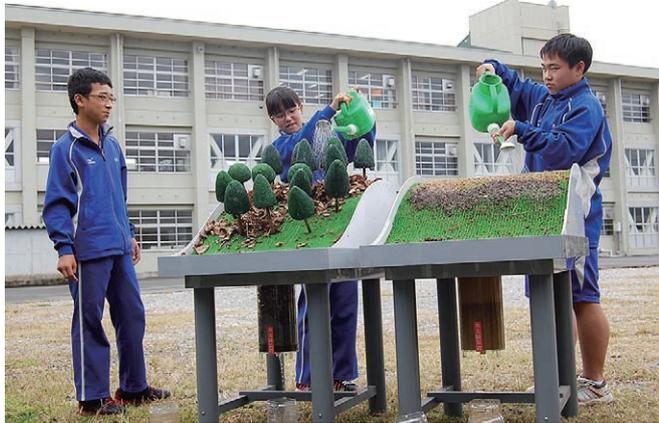
水の浸透実験装置を使つての実験
