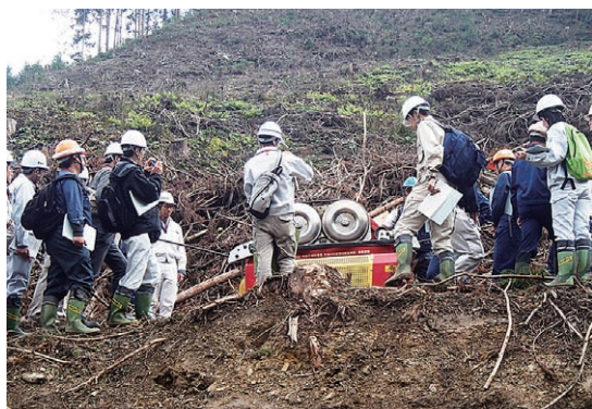
自走式搬器 （川井木材事業現場）
