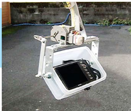
考案されたケーブルクレーン用カメラ (四万十署)
