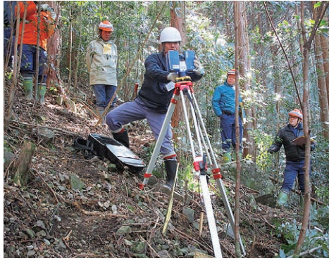
3Dレーザースキャナ計測の様子
