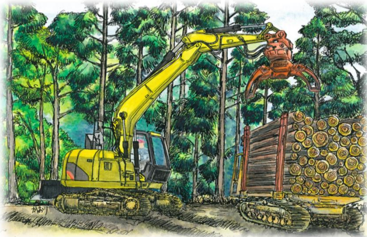
グラップルによるフォワーダへの積み込み作業
