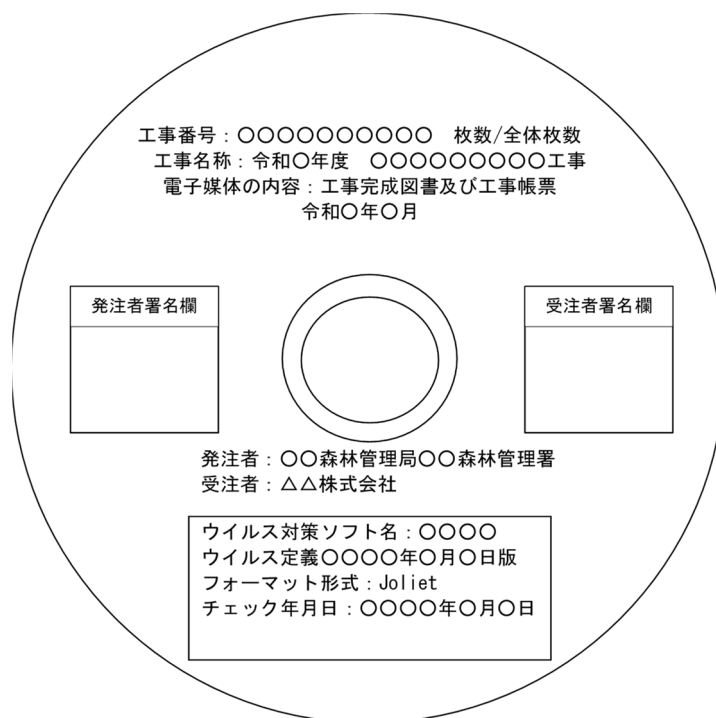
図 7-2 電子媒体への表記【工事】(例)
