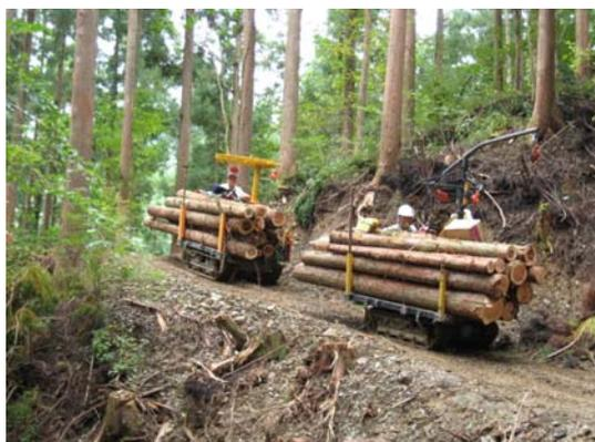
開設した作業道での間伐材の搬出状況
