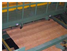
ロータリーレースでかつら剥きした単板
