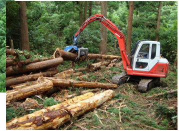
高性能林業機械（グラップル）を使った造材作業
