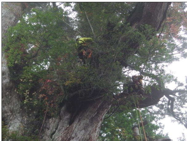
写真-4 根元から 4m 箇所の測定状況（左写真）、音響波計測診断器の測定状況（右写真）
