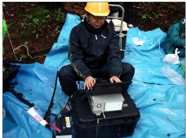
写真-4 根元から 4m 箇所の測定状況（左写真）、音響波計測診断器の測定状況（右写真）
