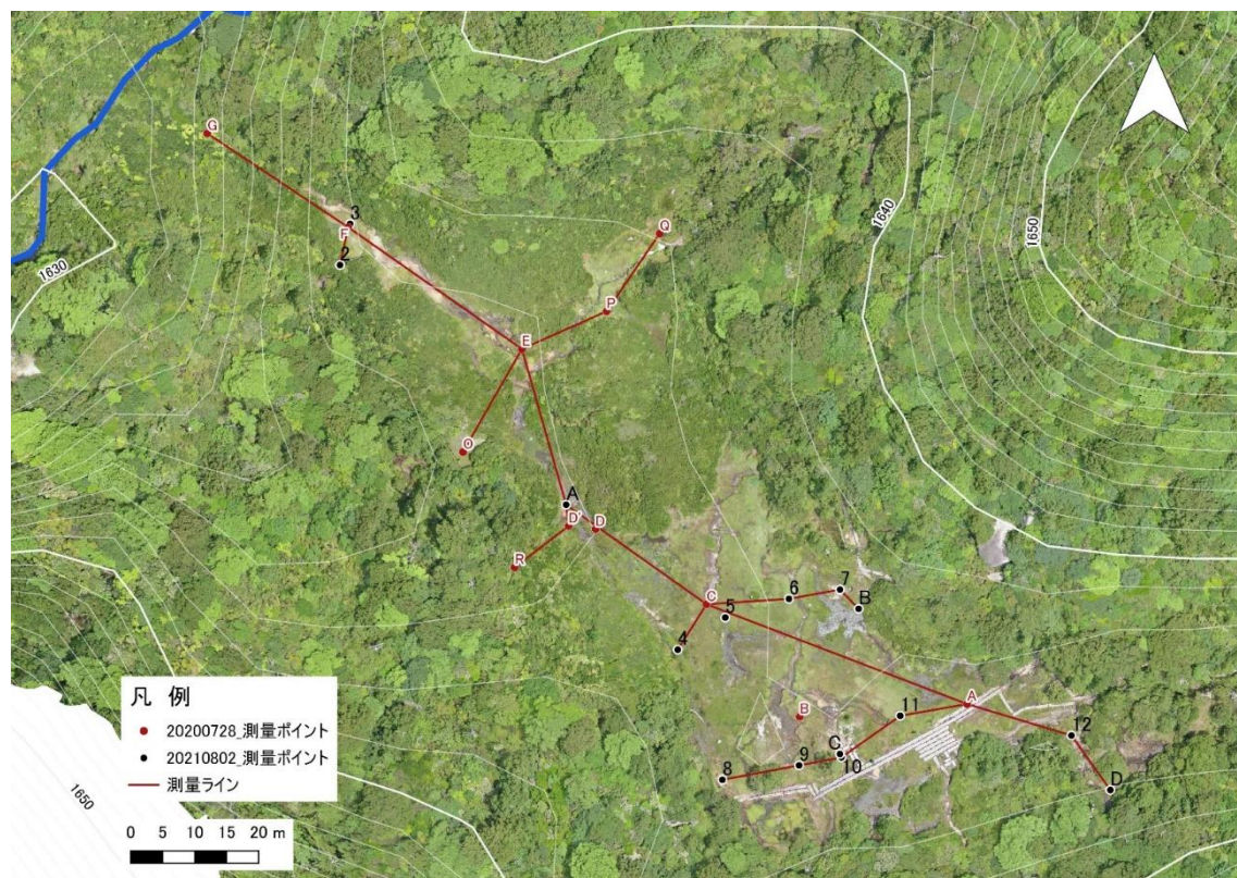
図6 縦断・横断方向のトラバース測量、基盤地質の調査地点
