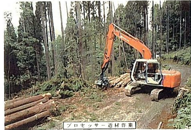
プロセッサー造材作業
