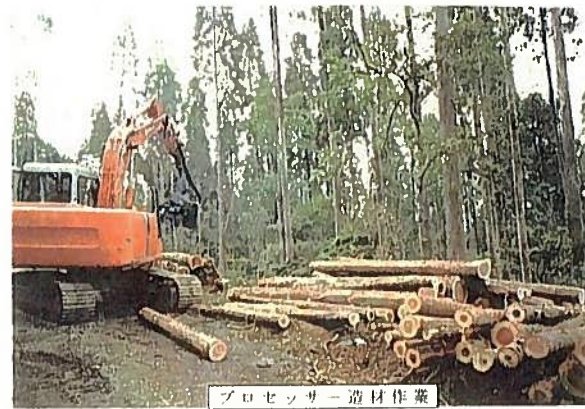
プロセッサー造材作業
