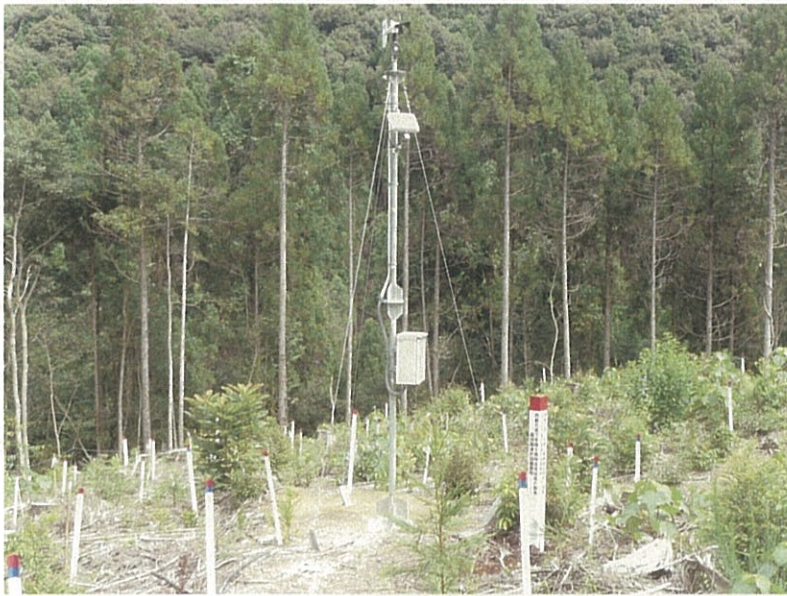
風速計設置状況
