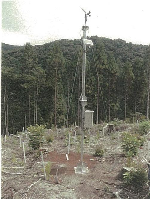
写真1 風向風速計設置状況
