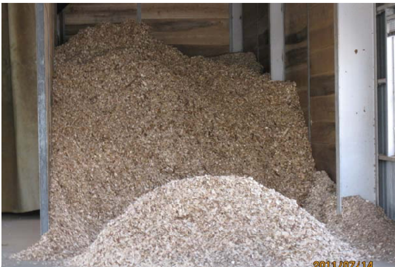
(上) C材未利用材等から (下) チップ（製紙用原材料）を生産
