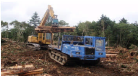
※伐採～木材搬出～コンテナ苗運搬 グラップルとフォワーダにより木材の搬出後、地拵が終了箇所コンテナ苗を運搬
