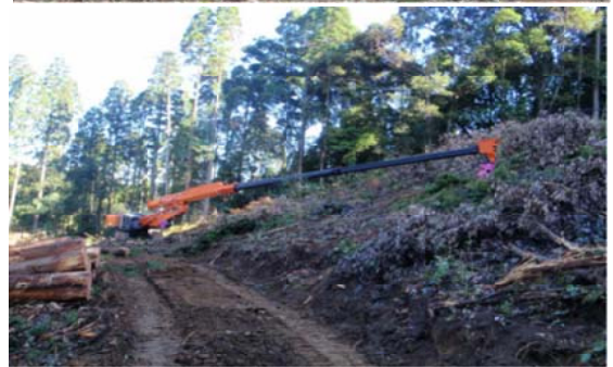
上：ロングリーチグラップルによる地拵え作業 下：ロングリーチグラップルによる集材作業
