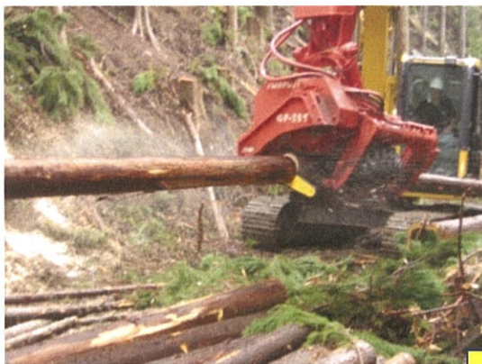
プロセッサによる作業状況（造材）
