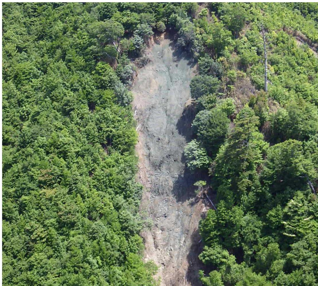
豪雨等により崩壊した林地を緑化する手段として、種子を混合した植生基材をヘリコプターで散布。
