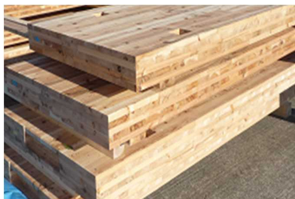
直交集成板 (CLT) (1m×3m×厚さ18cm 約220kg/枚)
