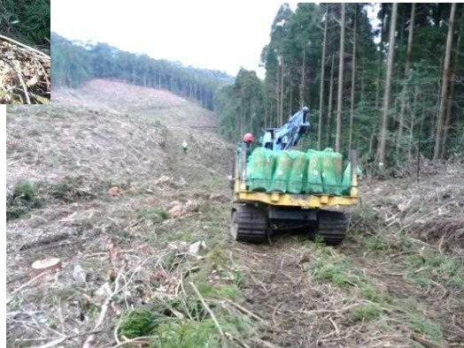
フォワーダによるコンテナ苗の運搬
