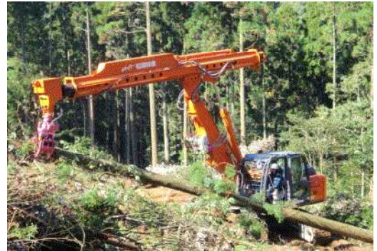
写真-1 ロングリーチグラップルによる集材
