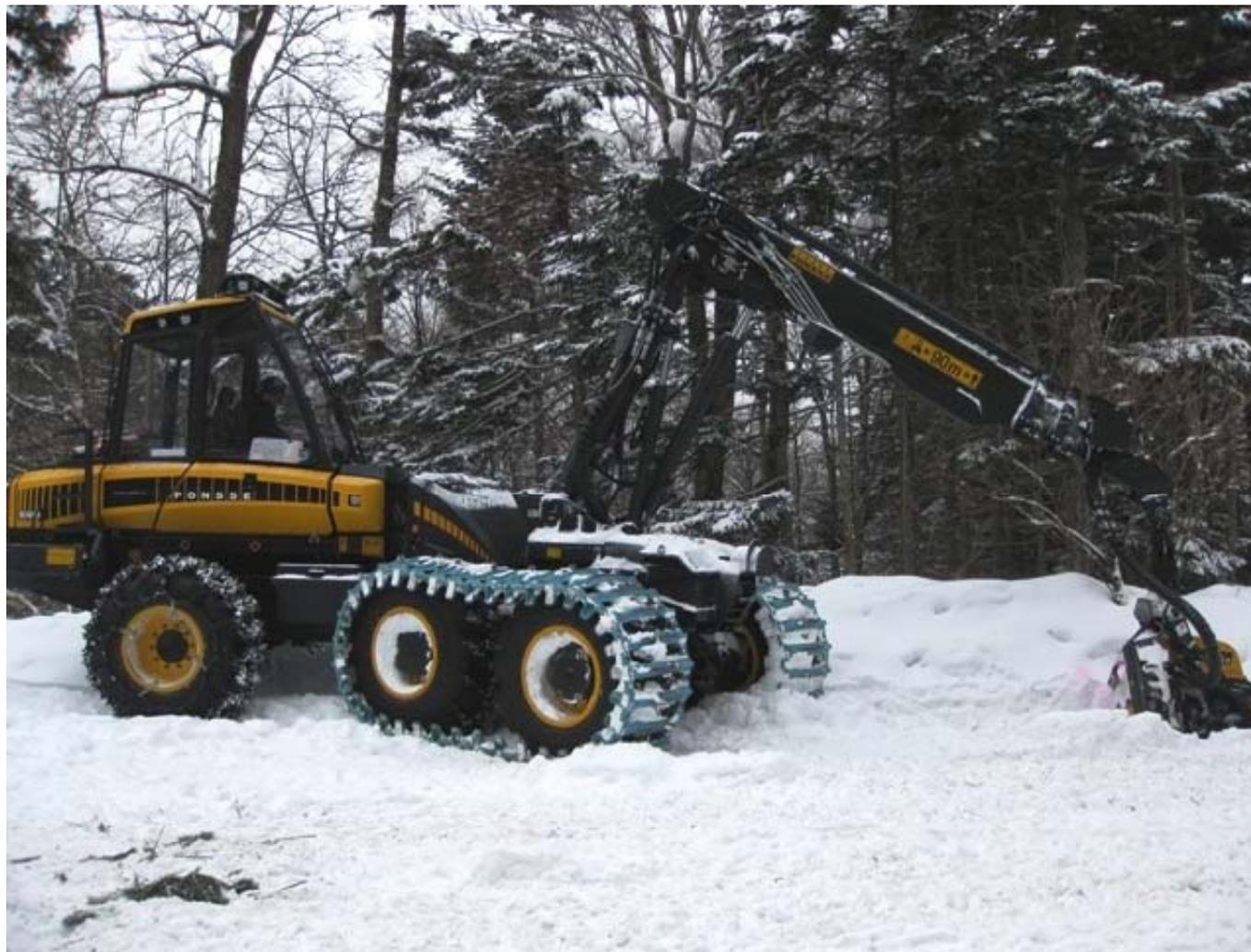
視界が良く快適なキャビン、10mのアーム、強力なエンジン(129kw)
