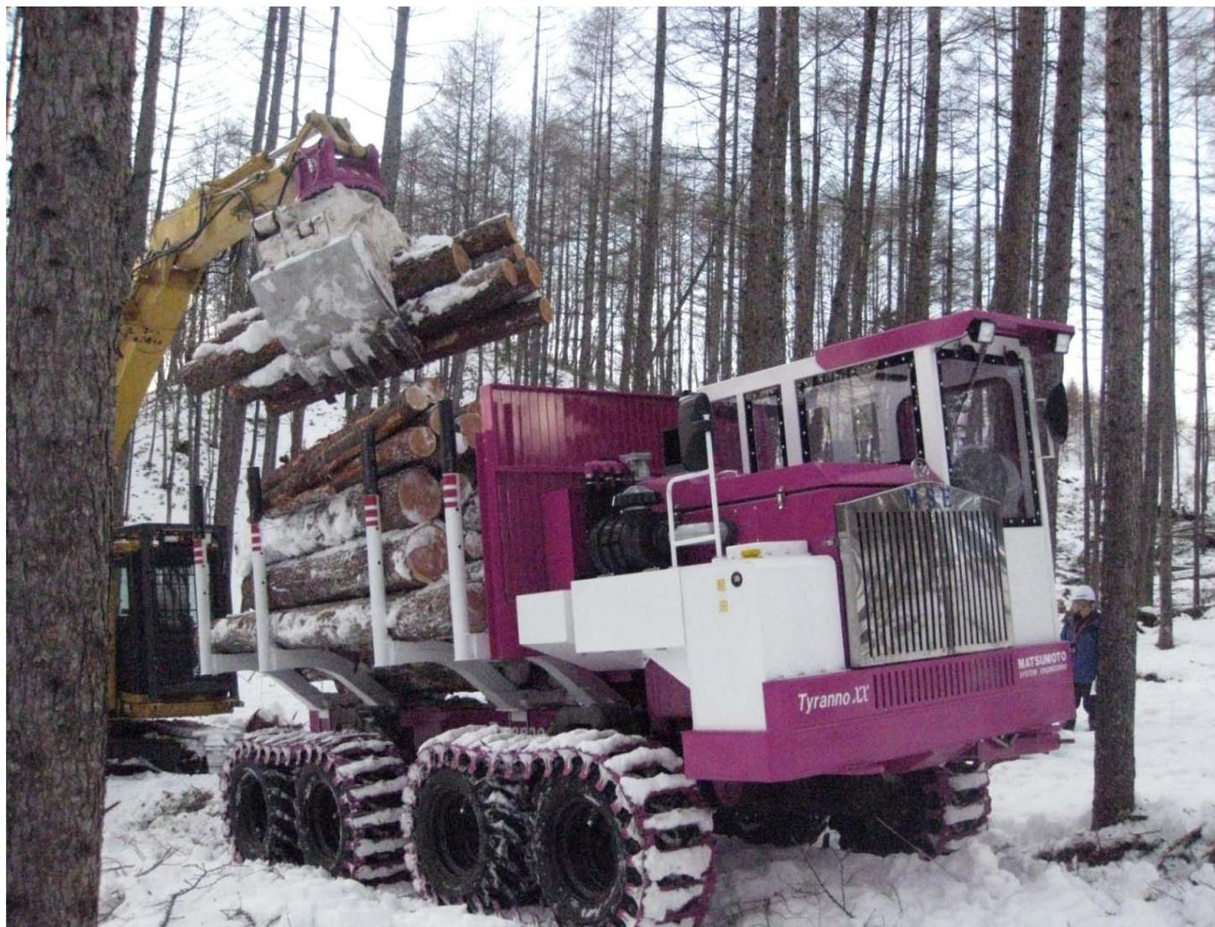
8輪独立懸架による強力な地形追従性、小さな回転半径、高速走行、フルキャビン
