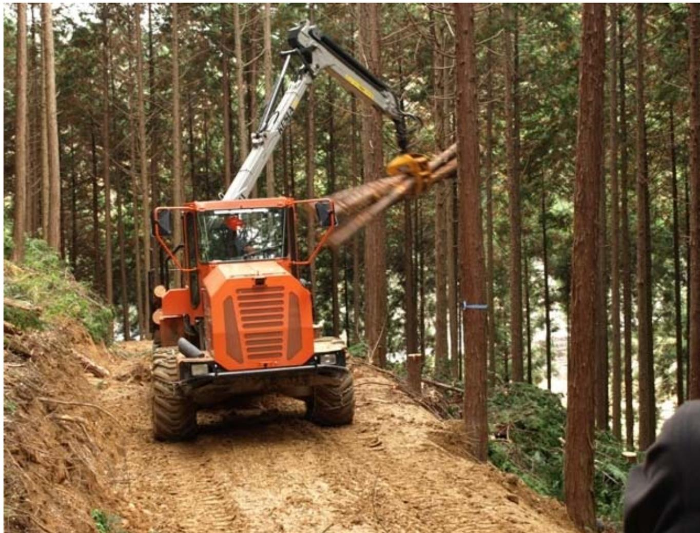
回転式シート、小さな回転半径、十分な速度、低い接地圧
