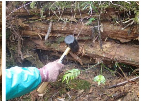
打込抵抗法（触診・打音：被害度3）
