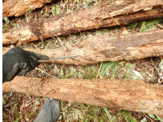
③中段切り生杭と丸太土留め 腐朽調査
