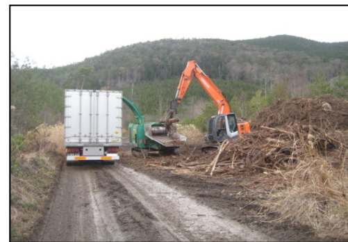
【末木枝条等の粉碎状況等の様子】
