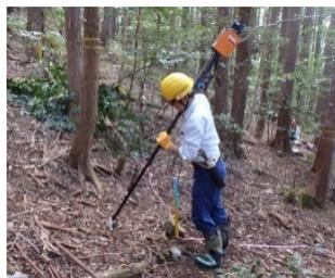
◀地上型三次元レーザー機器による計測
