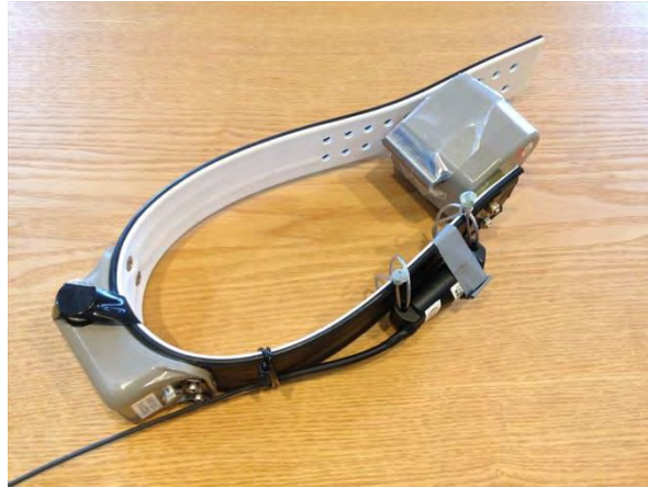
写真 3-1 使用した GPS テレメトリー首輪 追跡用発信器をベルトに装着している
