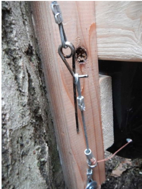
写真 3-11 作動しなかったトリガー部 チンチロが木材に触れ、蹴り糸が作動しているもののバネが引かれなかった。
