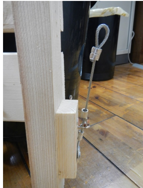
写真 3-12 トリガー部の改良 トリガー取り付け部に厚さ 2cm の木材を取り付け、チンチロが木材に触れないようにした。
