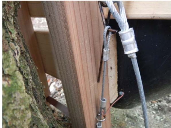
写真 3-3 トリガー部のチンチロが木材に引っかかり作動しなかった
