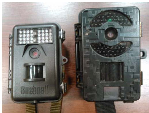
写真 1-1 使用したセンサーカメラ (左 : Trophy Cam 119436C および右 : STEALTH CAM STC-Q8XNG)
