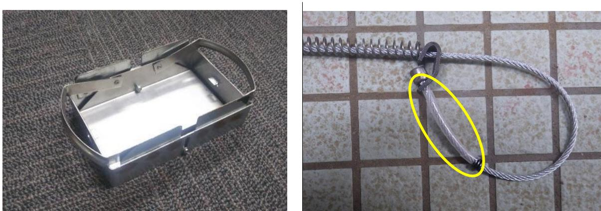
図 3-5 使用したくくりわなと合成樹脂で覆ったワイヤーのくくり部分
