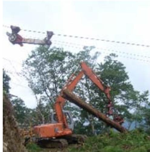
架線による集材とプロセッサによる造材
