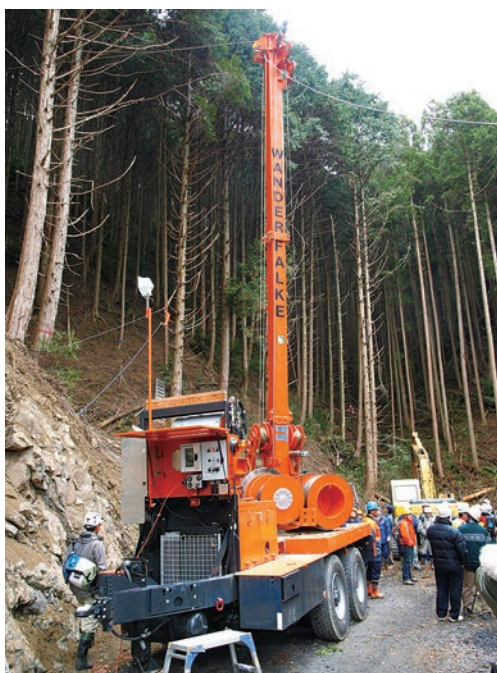
写真5-5 先進的な架線系林業機械の例
