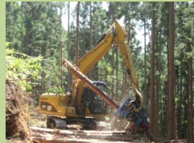
高性能林業機械（プロセッサ）を使用した丸太の生産 【広島北部森林管理署】
