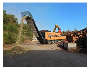
写真－6 ヤードでの破碎
