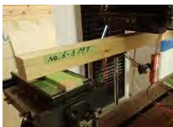
写真-7 LVLの曲げ強度試験
