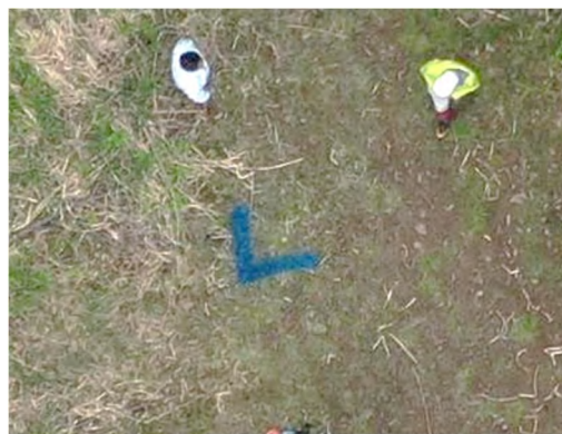
図-2 スプレーで描かれたGCPの例
