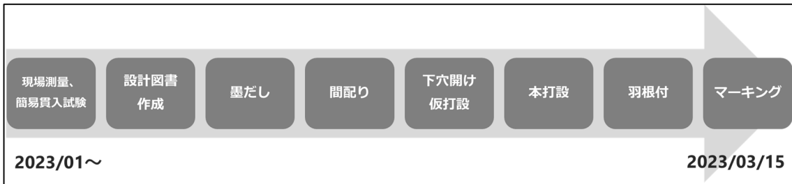
図-5 施工フロー
