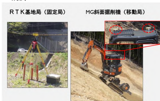
写真－3 MG 斜面掘削機のシステム概要①
