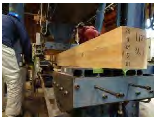
写真-6 集成材の曲げ強度試験
