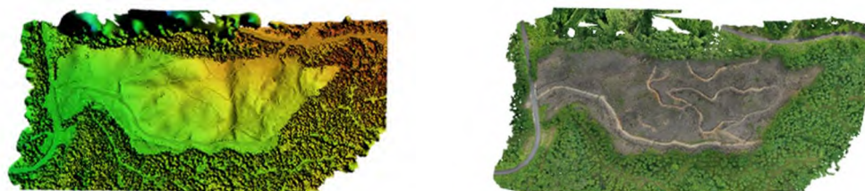
図-4 図-3の高密度点群モデルより構築されたDSM(上段)およびオルソ画像(下段)
