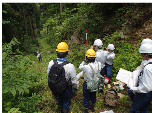
既設森林作業道の縦断勾配を確認
