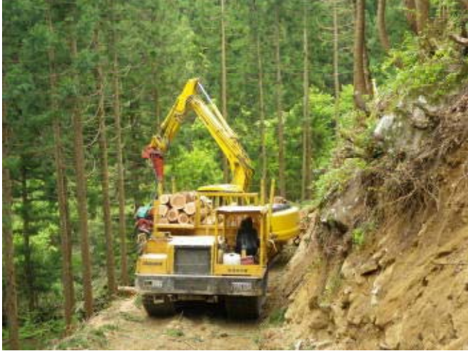
生産事業現場（宍粟市 鍋ヶ谷国有林） フォワーダによる運搬
