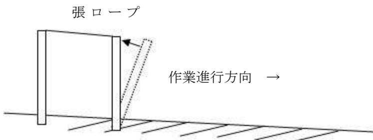
ロープの張力により支柱を引き起こし垂直(最もネットが高く)に仕上げる。
