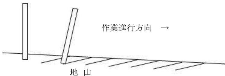
支柱は作業進行(斜面下方)方向へ傾けて打ち込む。
