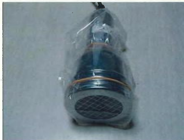
写真7 サーベイメータのビニール養生例
