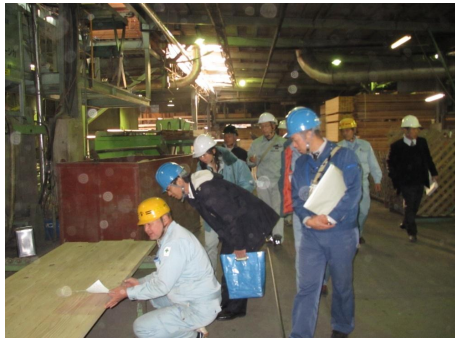
⑫ 集成材の製作ラインです。ジョイント(繋ぎ)部分を確認しています。
