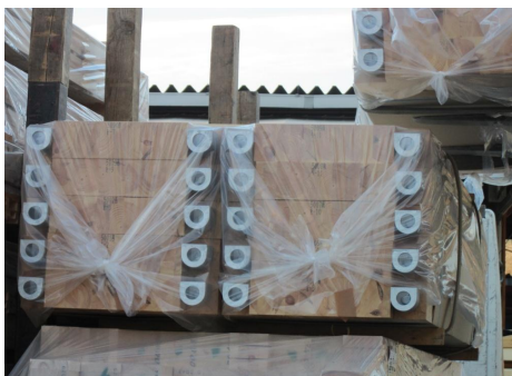
⑮ プレカットした材に金物も組み合わせます。
