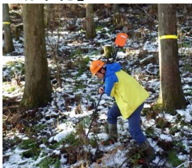
森林3次元計測システムOWLによるデータ取得状況（写真左）と現場でデータ化した画像（写真右）
