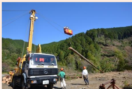
急傾斜地ではタワーヤードと自走式搬器 (往路で集材、復路でコンテナ苗を搬送)
