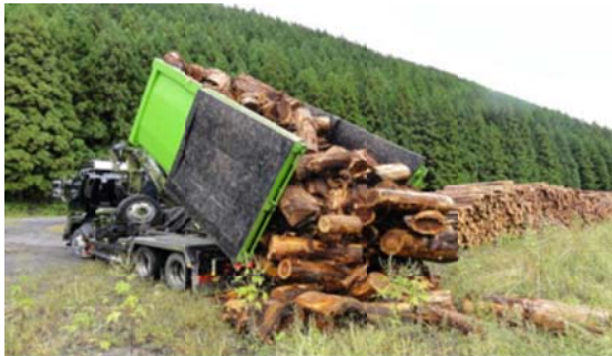
専用運搬車による林地残材搬出
