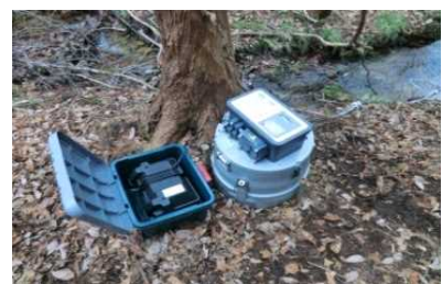
ウォーターサンブラ 1日1回、採取した水の放射性物質濃度を測定
