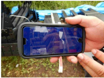
工事現場からスマートフォン等により映像・音声を監督職員へ送信
